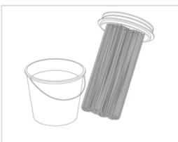
Достаем мембрану и в ручную убираем остатки грязи
